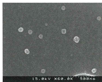
図 1.18 50nmPSL の FE-SEM 観察結果(x60000)
