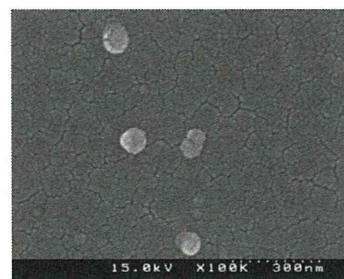
図 1.19 50nmPSL の FE-SEM 観察結果(x100000)
