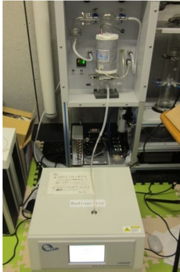
図 4.9 発生粒子粒度分布測定の実験風景
