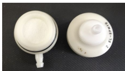
図 3.20(a) バグフィルターろ過材セット時のサンプラーの外観
