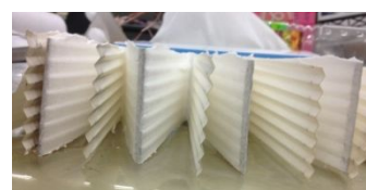
図 3.4(b) 正面から見た HEPA フィルター内部
