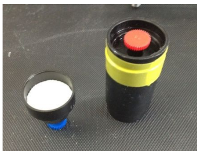
図 3.17(a) バグフィルターセット時のディスポーサブルサンプラー外観
