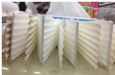
図 3.26(b) HEPA フィルター内の ろ過材を正面から見た図
