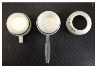
下段 中段 上段 図 3.12(a) フィルターセット時のオープンフェイスサンプラーの外観
