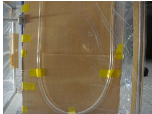
図 3.13(b) 圧損計の外観
