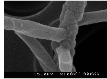
図 1.74 MWCNT, 1.0 \times 10^{-6} wt%の FE-SEM 観察結果(100000 倍)
