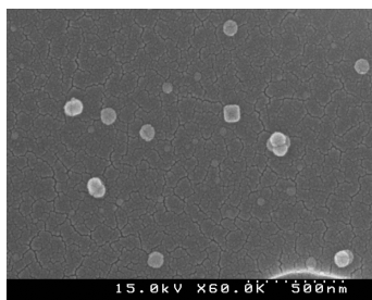
図 1.18 50nmPSL の FE-SEM 観察結果(x60000)
