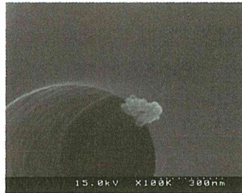
図 5.31 清掃作業時の LD-6N による呼吸器付近の粒子捕集例 (100000 倍)
