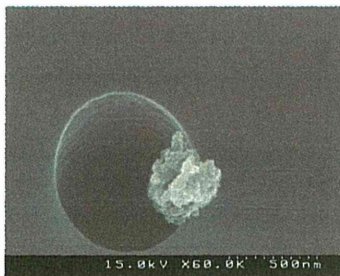
図 5.22 清掃作業時の Sioutas (E層) による 粒子捕集例 (60000倍)
