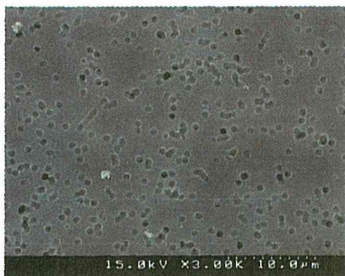
図 5.21 清掃作業時の Sioutas (E層) による 粒子捕集例 (3000倍)
