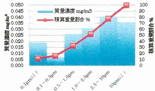
図 5.8 Sioutas①による捕集粒子の粒度分布 図 5.9 ナノサンプラー捕集粒子の粒度分布
