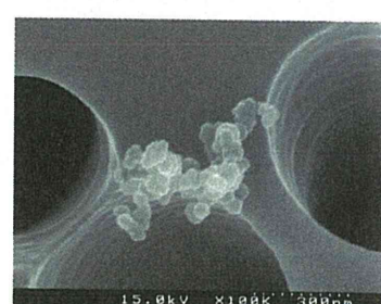
図 5.14 充填作業時の オープン①による 粒子捕集例 (100000 倍)
