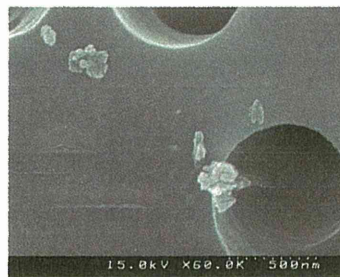
図 5.19 清掃作業時の オープン②による 粒子捕集例 (60000倍)
