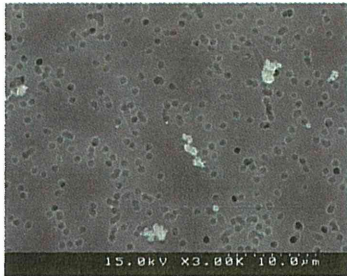
図 5.29 清掃作業時の LD-6N による呼吸器付近の粒子捕集例 (3000 倍)
