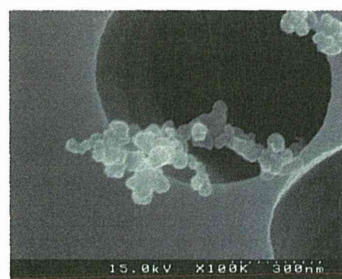
図 5.36 バックグラウンド測定におけるオープン③による粒子捕集例 (100000 倍)
