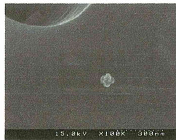
図 5.20 清掃作業時の オープン②による 粒子捕集例 (100000倍)
