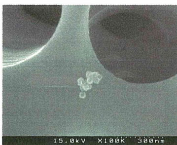
図 4.20 C2(RL2)を通過した 粒子(凝集体) (試験粒子：二酸化チタン)
