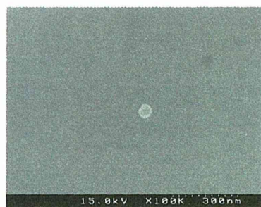
図 4.19 R2(RL2)を通過した 単体粒子 (試験粒子：二酸化チタン)
