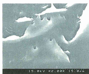
図 3.29 仕切り板ろ過材の表面形態 (×2000)
