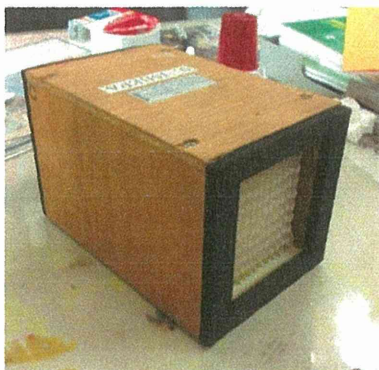
図 3.25(a) HEPA フィルター全体の外観
