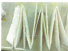
図 3.4(a) 上方から見た HEPA フィルター内部
