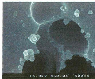
図 1.88 フラーレン 1.0×10 -4 wt%の FE-SEM 観察結果(60000倍)
