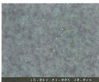
図 1.53 100nmTiO 2 , 1.0x10 -8 wt%の FE-SEM 観察結果(×1000)
