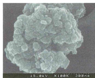
図 1.55 100nmTiO 2 , 1.0x10 -8 wt%の FE-SEM 観察結果(×100000)
