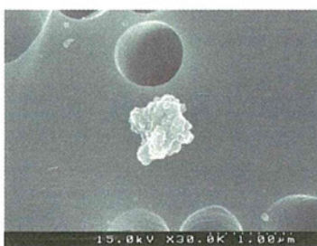
図 1.54 100nmTiO 2 , 1.0x10 -8 wt%の FE-SEM 観察結果(×30000)
