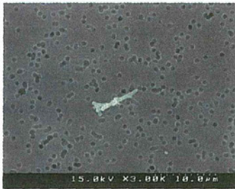
図 1.77 MWCNT, 1.0×10 -8 wt%の FE-SEM 観察結果(3000 倍)
