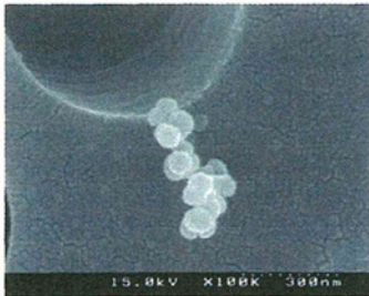
図 1.105 銀ナノ粒子の 1.0 \times 10^{-8} wt% の FE-SEM 観察結果(3000倍)
