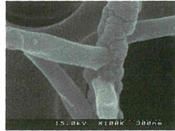
図 1.74 MWCNT, 1.0×10 -6 wt%の FE-SEM 観察結果(100000 倍)
