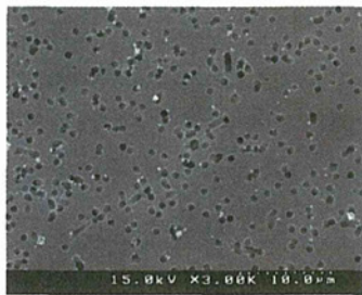
図 1.38 50nmTiO 2 , 1.0×10 -6 wt%の FE-SEM 観察結果(×3000)
