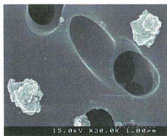
図 1.49 100nmTiO 2 , 1.0 \times 10^{-6} wt% の FE-SEM 観察結果(×30000)
