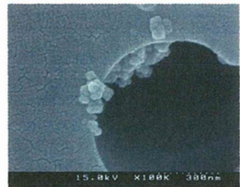
図 1.94 フラーレン 1.0 \times 10^{-6} wt% の FE-SEM 観察結果(100000 倍)
