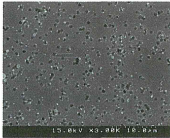
図 1.21 100nmPSL の FE-SEM 観察結果(x3000)
