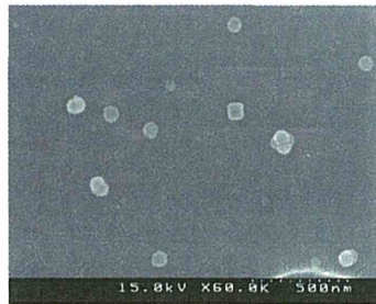
図 1.18 50nmPSL の FE-SEM 観察結果(x60000)
