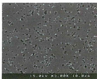
図 1.26 300nmPSL の FE-SEM 観察結果(x3000)
