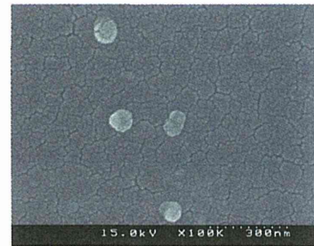
図 1.19 50nmPSL の FE-SEM 観察結果(x100000)
