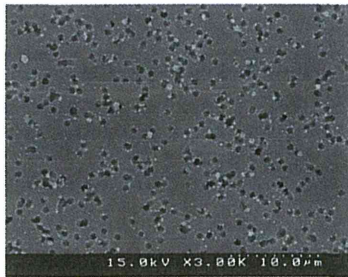
図 1.17 50nmPSL の FE-SEM 観察結果(x3000)
