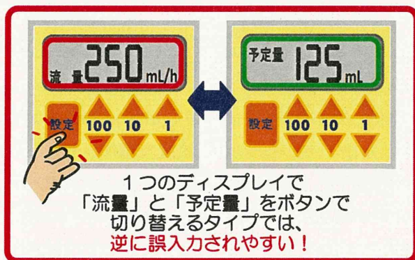
Fig.15. 医療事故防止対策適合以前の入力方法における注意点 [資料 6]
