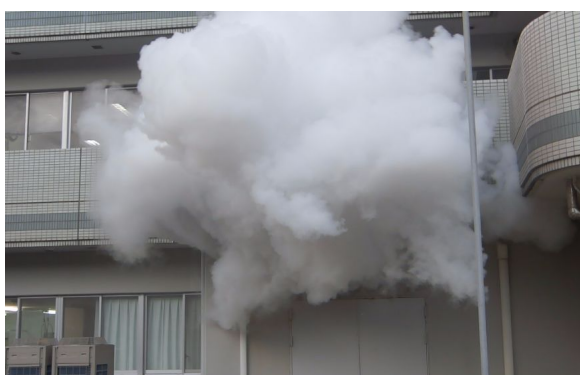
真空開放と同時に大量放出が始まった
