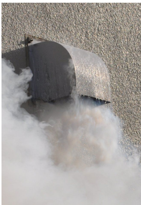
(c)約 6 分後のダクトカバー 表面で凝縮液化する空気
