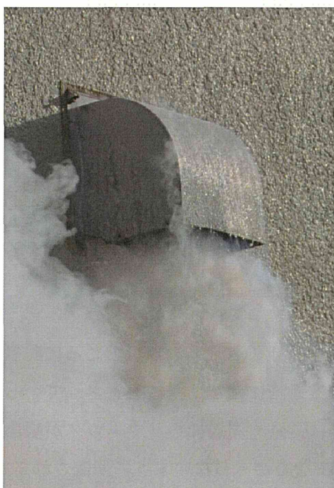
(c)約 6 分後のダクトカバー 表面で凝縮液化する空気
