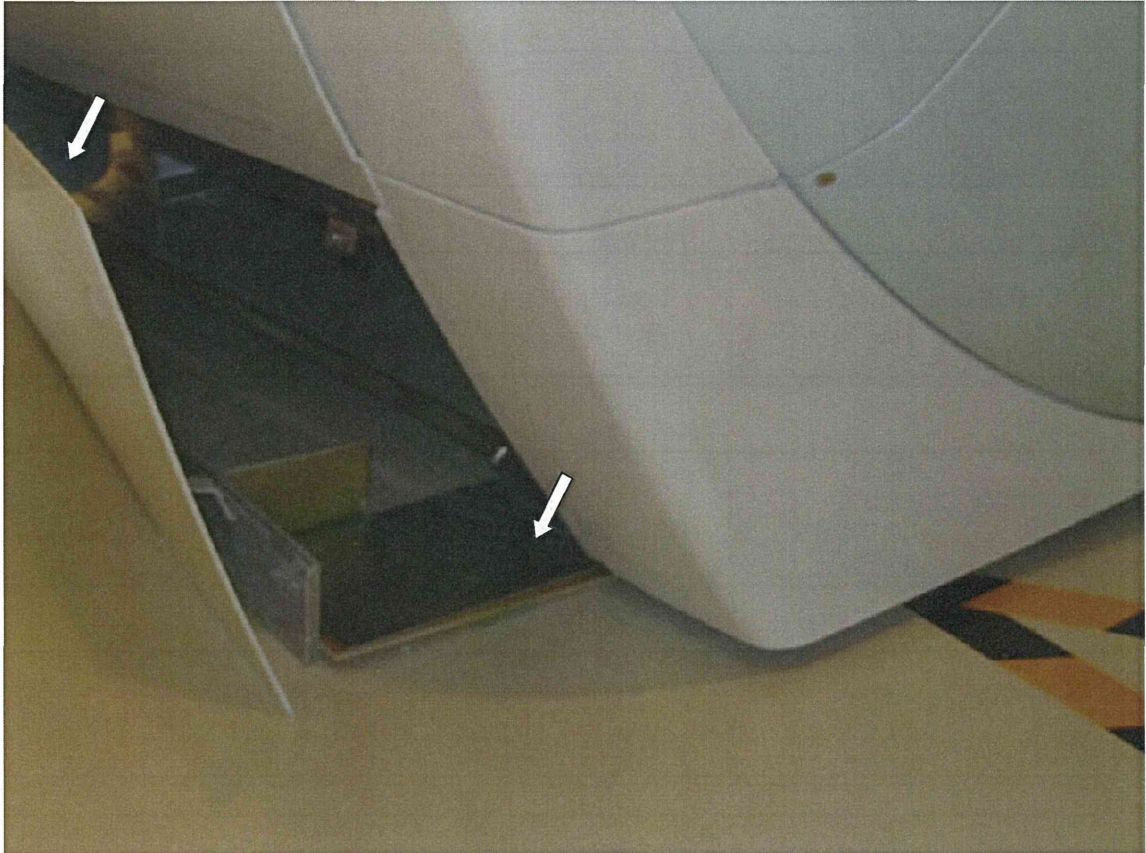
図3 MR装置の外装パネルの破損：MR装置が移動し、筐体下部の外装パネルが剥離している（白矢印）。床上に見える金属板はマグネットを配置するために床上に敷かれていたが、マグネットはその金属板の上を滑って移動している。
