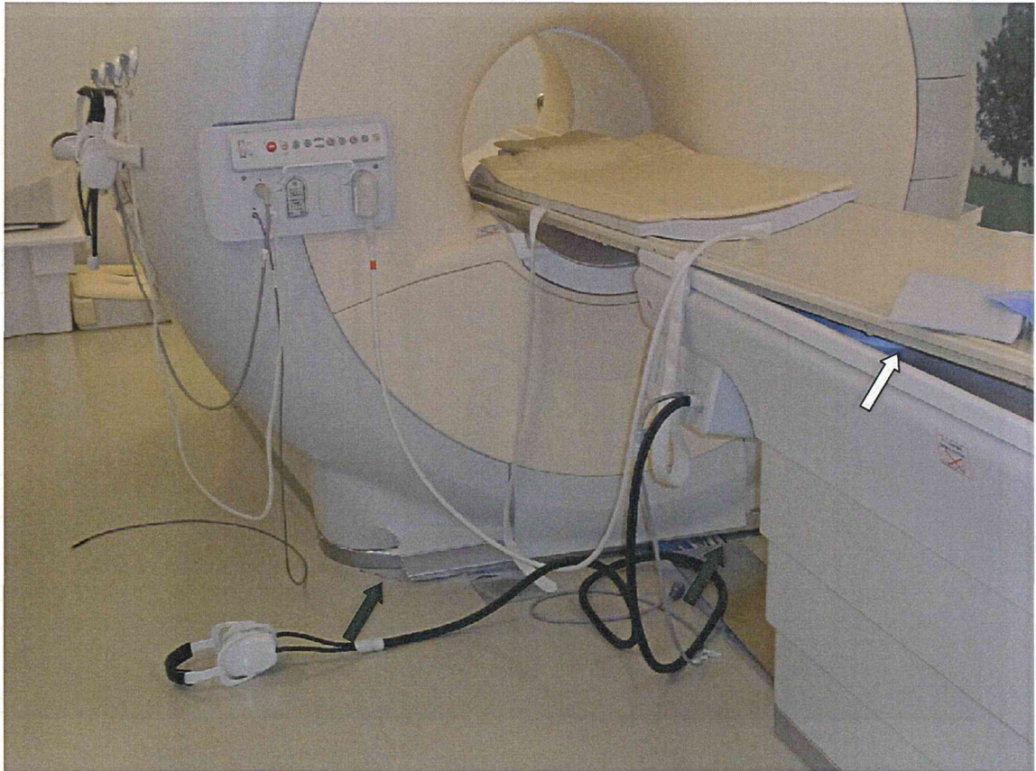
図1 MR装置の破損例：MR装置の移動及び寝台の破損。マグネット（撮影装置）が本来の位置から向かって左側に移動し、筐体脚部が破損しピット内の配線が見えている（黒矢印）。マグネット移動の結果、手前にある寝台本体との位置関係がずれ、寝台の天板がレールから外れている（白矢印）。
