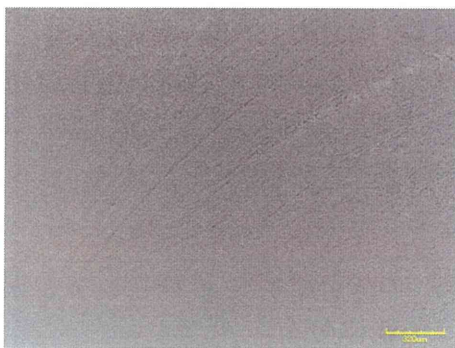
図 10(a). 試験後の未処理 CLPE ライナー摺動面の LSM 像
