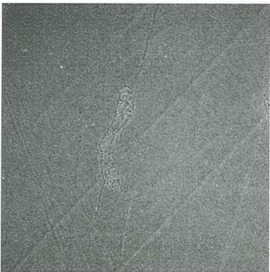
図 14(b). MPC 処理 CLPE ライナーと組み合わせて使用した Co-Cr 骨頭の試験後表面の SEM イメージ
