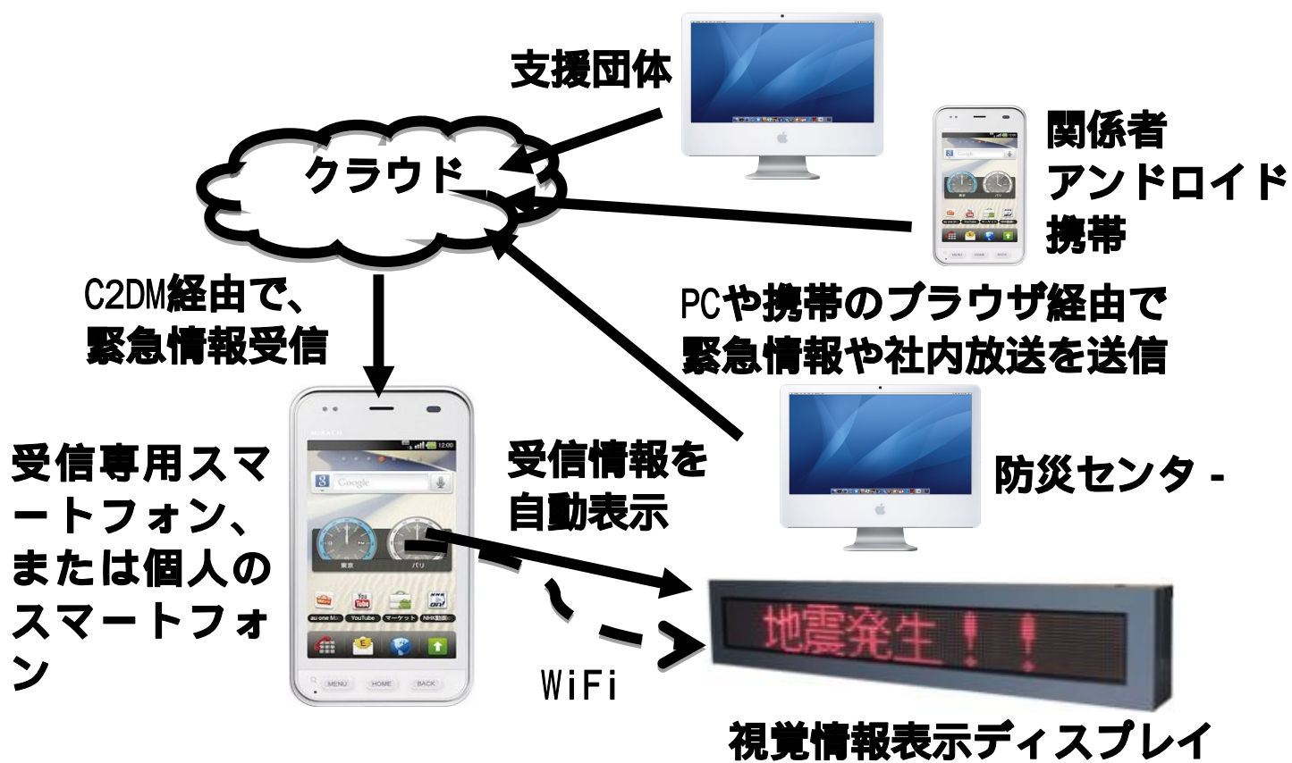
図1. 聴覚障害災害時要援護者支援情報機器構成図
