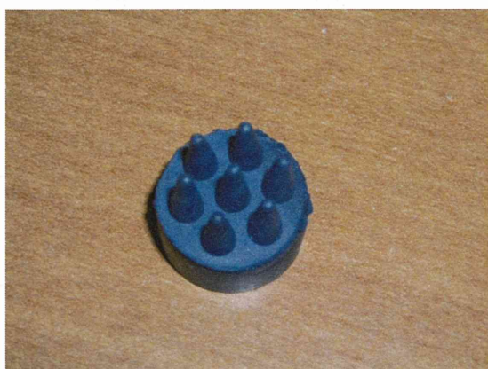
図 7 カーボン粒子含有導電性シリコンゴム電極
