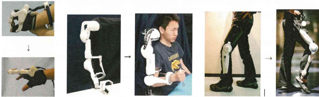
図1 装着型サイバニックハンド・フィンガー、上肢用 HAL、単関節下肢用 HAL(改良版)
