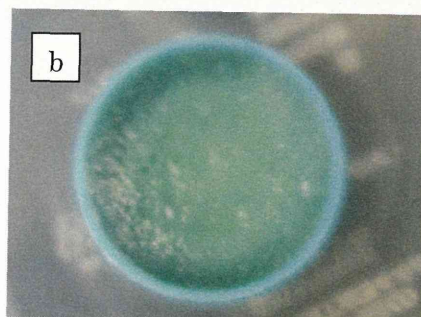
図8 ディスペンサー法によるゲルチップの作製
