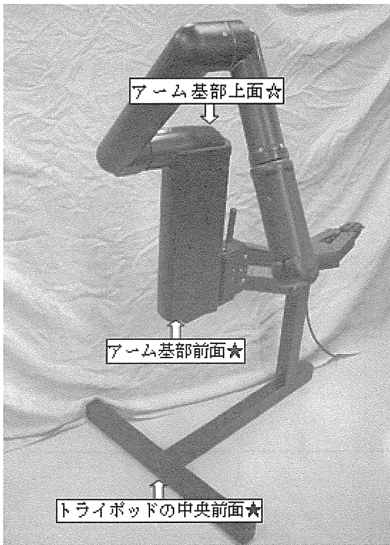
図1 iARM 開始位置および基準点
