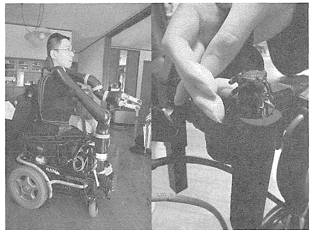
図 II-2-1 長期評価実験のロボットアーム取付状況
