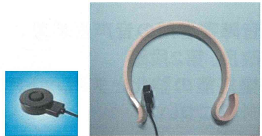
図3 皮膚伝導マイクと試作の頸部への固定具
