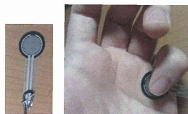
図1 押圧センサ FSR と取り付け位置
