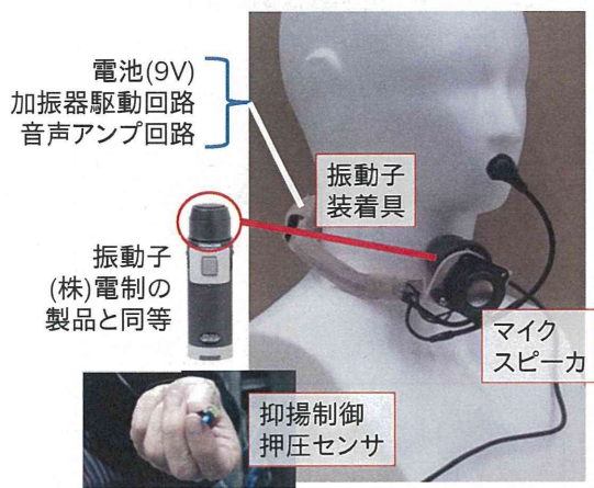
図5 試作機2. 拡声器と本体(制御部)を首バンドに取り付け、抑揚センサを指先で持つトータル人工喉頭システム。なお、振動子としては既実用化し普及している人工喉頭「ユアトーン」のものをそのまま利用している。
