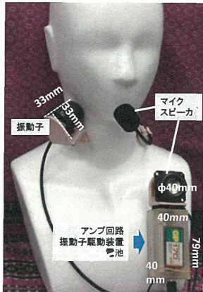
図4 試作機1. 拡声器、スピーカ、電源を別ケースと本体の制御部を首バンドに取り付け、抑揚センサを指先で持つトータル人工喉頭システム
