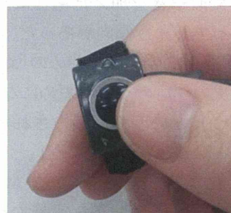
図9 ハンズフリー電気喉頭の抑揚制御センサ試作器
