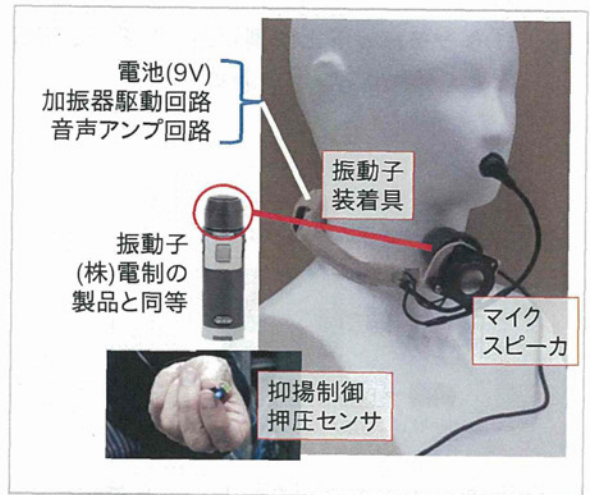
図4 上図: 首バンドに加わる各種の力を計算し、振動子の押圧力が首に適切に加わるようにした。下図: 拡声器を取り付けたトータル人工喉頭システム
