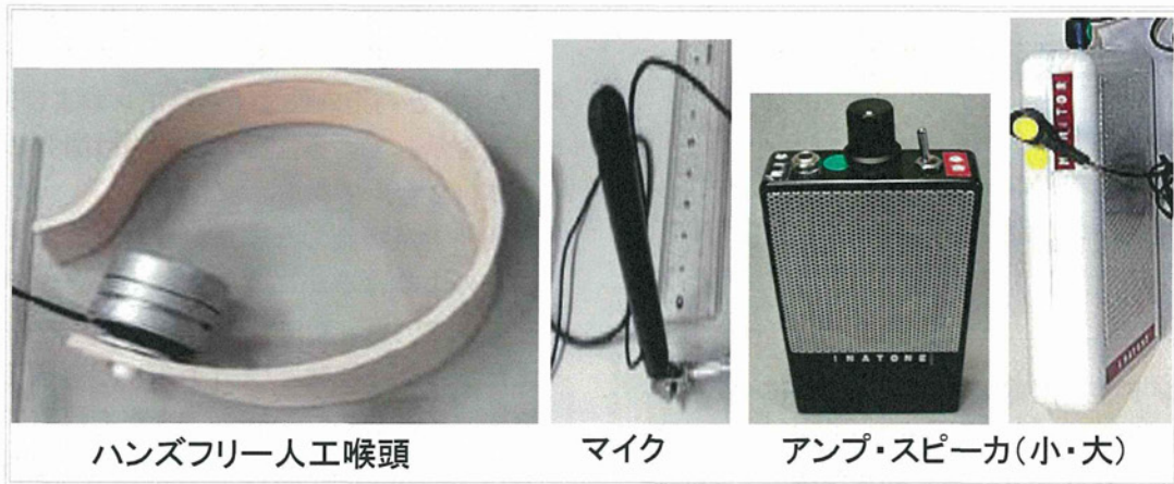
図1 ハンズフリー人工喉頭(左図)と高指向性マイクロホン(中央)およびアンプ本体(右図)
