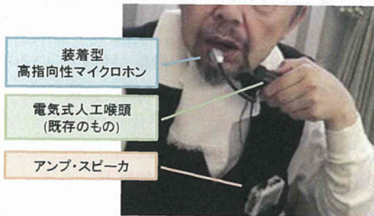
図3 ① マイクの指向性と音源の関係図、② 電気人工喉頭のための拡声器 (協力: 株式会社サザン音響)、③ 開発中の拡声機の使用例
