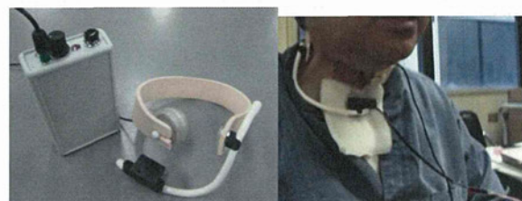
図2 首バンド（左図）を全周囲型とし、抑揚センサとして押圧センサ（右図）を利用。
