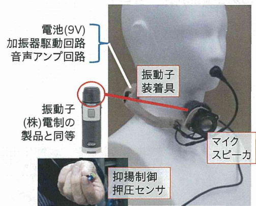
図5 拡声器と本体(制御部)を首バンドに取り付け、抑揚センサを指先で持つトータル人工喉頭システム。なお、振動子としては既に実用化し普及している人工喉頭「ユアトーン」のものをそのまま利用している。
