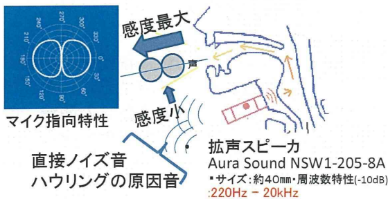
図1 人工喉頭用マイクロホンの設計原理
