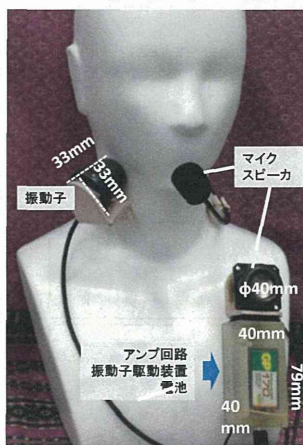
図4 拡声器、スピーカ、電源を別ケースと本体の制御部を首バンドに取り付け、抑揚センサを指先で持つトータル人工喉頭システム。
