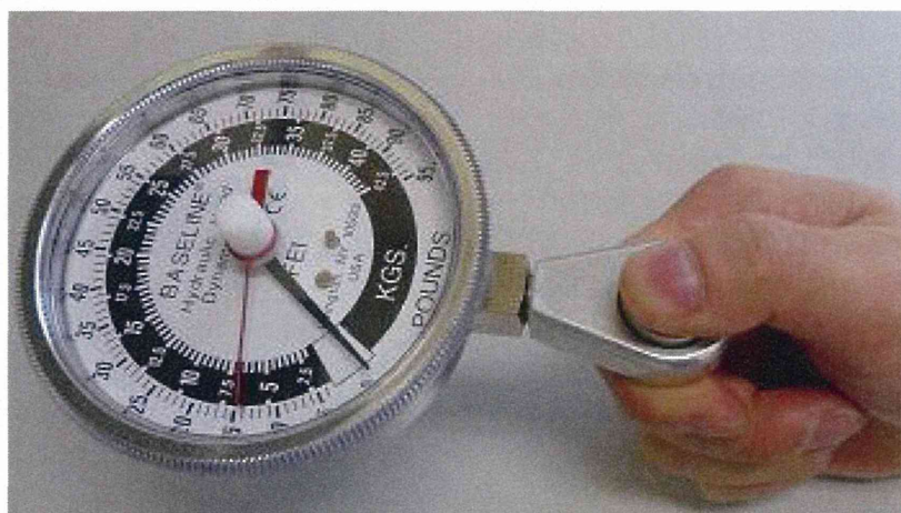
図2. ピンチ力の測定
