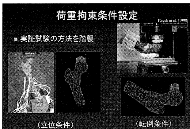
図2. 大腿骨近位部の圧縮試験
