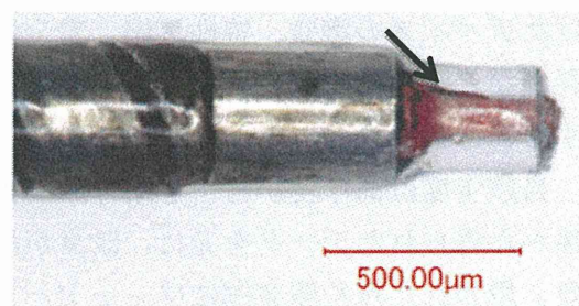
図 C.2 センサ部位拡大写真 極細径光ファイバ圧力センサの先端部分に血栓が形成されている。(矢印)
