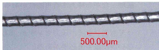
図 C.2 被覆付光ファイバ圧力センサに使用する SUS 平線コイル
