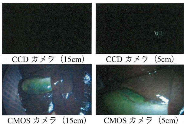
Fig. 6 LED 光源 (1W) 使用時の CMOS カメラ試作機と 3CCD 型カメラのブタ肝臓画像比較.
