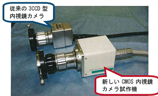
Fig. 1 CMOS カメラ試作機と従来の 3CCD 型カメラ
