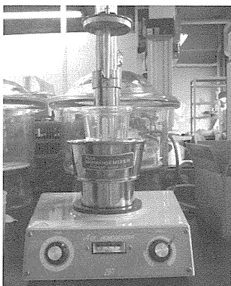
1%コラーゲン溶液をエースホモジナイザーで8000回転15分攪拌する
