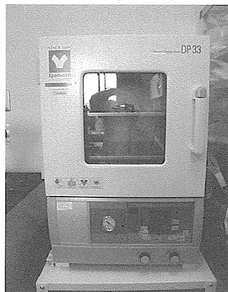
角形真空定温乾燥器で140℃、24時間熱架橋する
