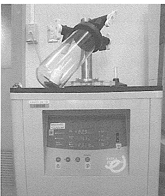
凍結乾燥型で人工材料型を付けて3~5日、はずして2日ぐらい乾燥する
