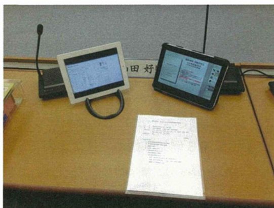
図 5. 左が資料レビュー用、右が今回試作したシステムのタブレット端末
