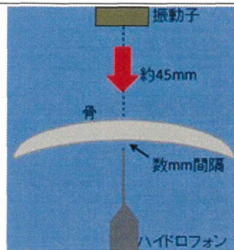
図9 振動子と骨片とハイドロフォン
