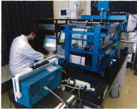
図6 AIMSによる音場分布測定シーン
