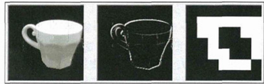
図 5 コーヒーカップをエッジ抽出(Sobel)し、2 値の 7×7 に変換
