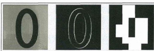
図 3. 数字の 0 をエッジ抽出(Sobel)し、2 値の 7×7 に変換
