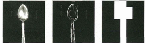
図 6 スプーンをエッジ抽出(Sobel)し、2 値の 7×7 に変換
