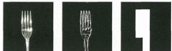
図 7 フォークをエッジ抽出(Sobel)し、2 値の 7×7 に変換
