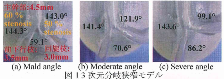
図1 3次元分岐狭窄モデル
