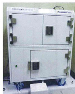
第32図 医療機器申請を前提に製造された迅速ガスPET対応型の 15 O-標識ガス自動合成・供給システムの外観。
