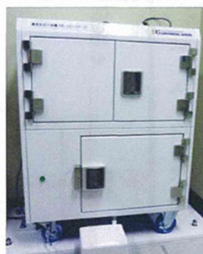
第32図 医療機器申請を前提に製造された迅速ガスPET対応型の ^{15}\text{O} -標識ガス自動合成・供給システムの外観。
