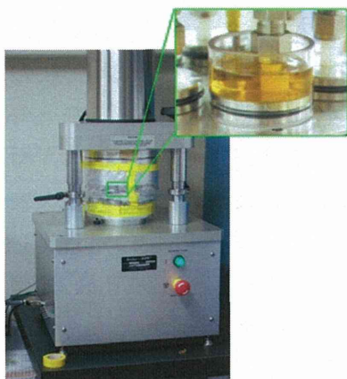
図 1. Pin-on-disk 型摩耗試験装置 (AMTI 製 Ortho-POD)
