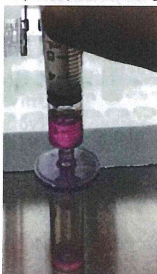
図 4. シリンジに取り付けたフィルターでの原虫濾過
