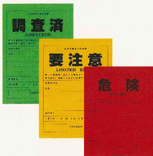
図1. 被災建築物応急危険度判定の表示
