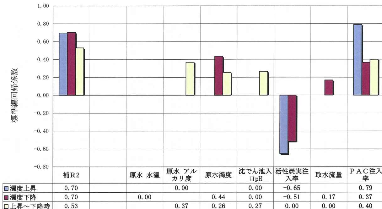
図-7 沈澱池出口濁度に関する標準回帰係数（3系統）濁度削除あり
