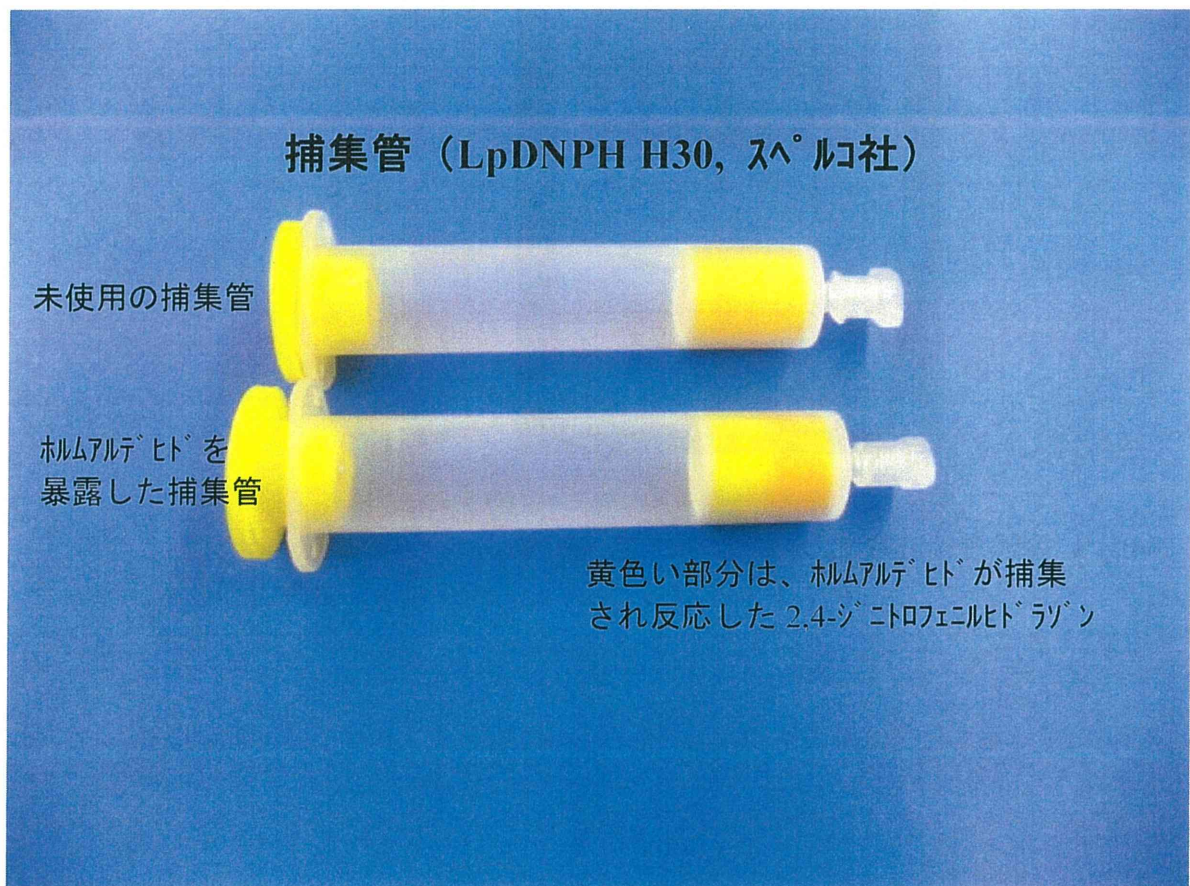
図 5. ホルムアルデヒドを暴露し、捕集管に捕集され、反応した 2,4-ジニトロフェニルヒドラゾン
