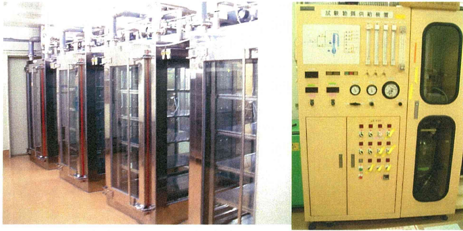
Photo 1 3m 3 横層流大型チャンバー及びその発生装置 (柴田科学)
