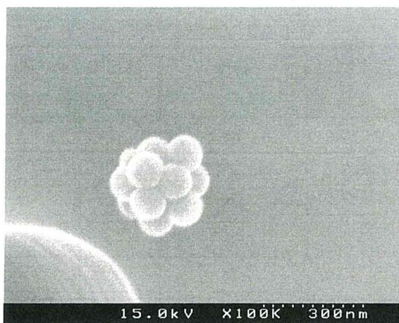
図 3.2.18 L2W(RL2)を通過した粒子(凝集体)(ポリスチレンラテックス粒子)
