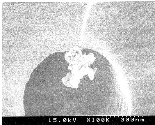
図 3.2.25 L (RL1) を通過した粒子(凝集体)
