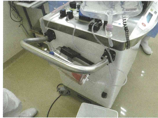
図 5 “閉鎖”回路細胞精製分離 Celution システム
