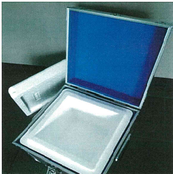
図 4. 空冷輸送用ジェラルミンケースの例 (研究班制作品：4.5kg, 1L 容器 1~2 個, ドライアイスを使用できる様発泡スチロールを容器内に入れて)
