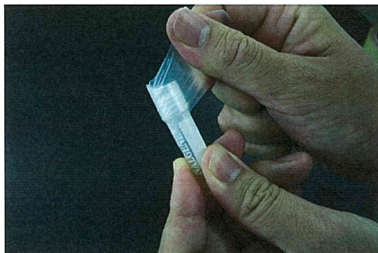
写真3 防漏対応としてパラフィルム密封
