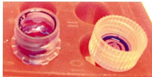
4. 薄膜形成とキャップの形状の相関を調べたところ、図に示すようにキャップの底面が平らな形状で本体の内部に沿うような突起を有する構造のキャップにしばしば観察された（下図、デザインB）。これはOリングの有無には関係しなかった。
