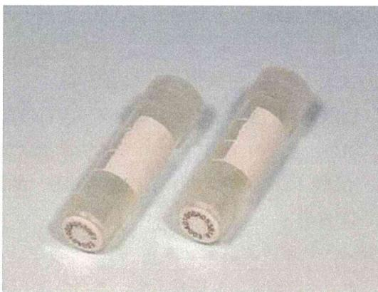
図 2. セラミック製 IC タグ付試料容器
