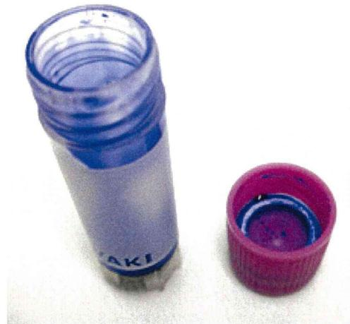
5. 再キャッピングによりスクリー部分に内容物が滲出するかを調べたところ、2回までは確認できなかったが、3回の連続した再キャッピングにより多くの一次保存容器で滲出を確認した。
