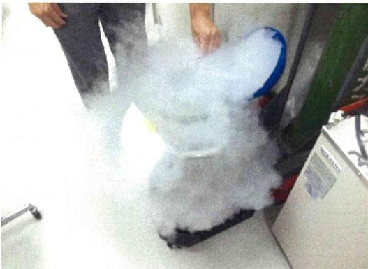
写真：液体窒素にICタグを入れての実験
