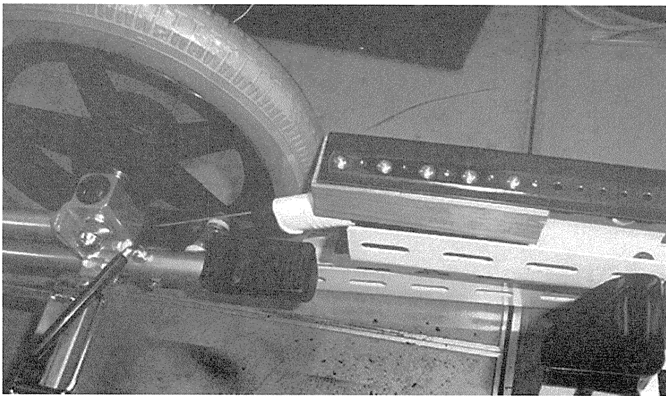
図2 繰り返し試験装置の介助用ブレーキ負荷部分
