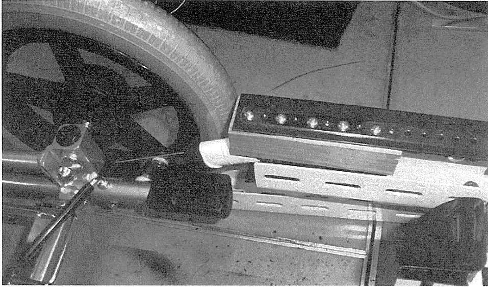
図2 繰り返し試験装置の介助用ブレーキ負荷部分
