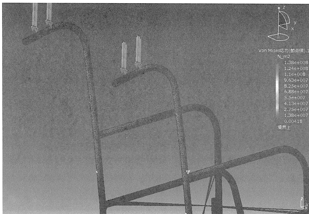
図 8-2 グリップ部から背フレームの拡大 高い応力部分を拡大して示したものである。 図 9 は、手押し及び足踏みの場合の解析状況である。
